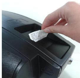
Retire o comprovante de registro de ponto do suporte na lateral do equipamento.
