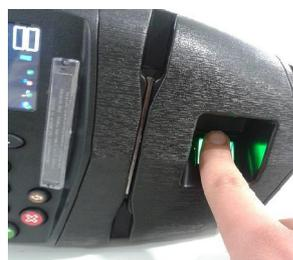
Posicione o dedo sobre o sensor biométrico.
