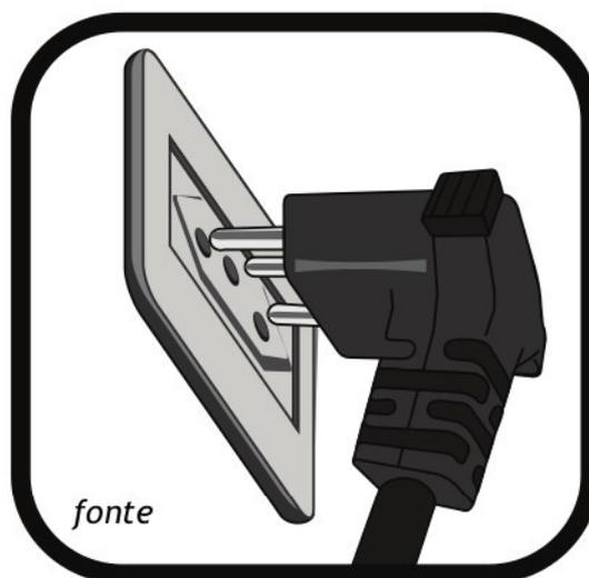
O equipamento utiliza fonte chaveada externa com entrada de 100 a 240 Vac e saída de 9V 3A, não é recomendado estender o cabo de saída da fonte.
